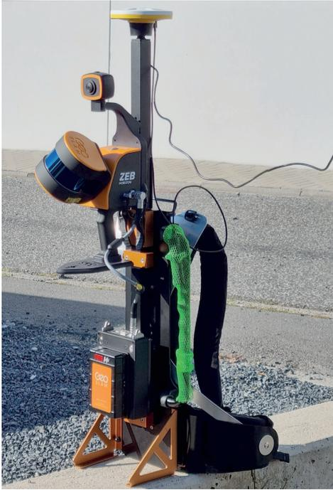
Abb. 2: Einsatzbereiter Rucksack-Scanner mit Scanner, Panoramakamera und GPS
