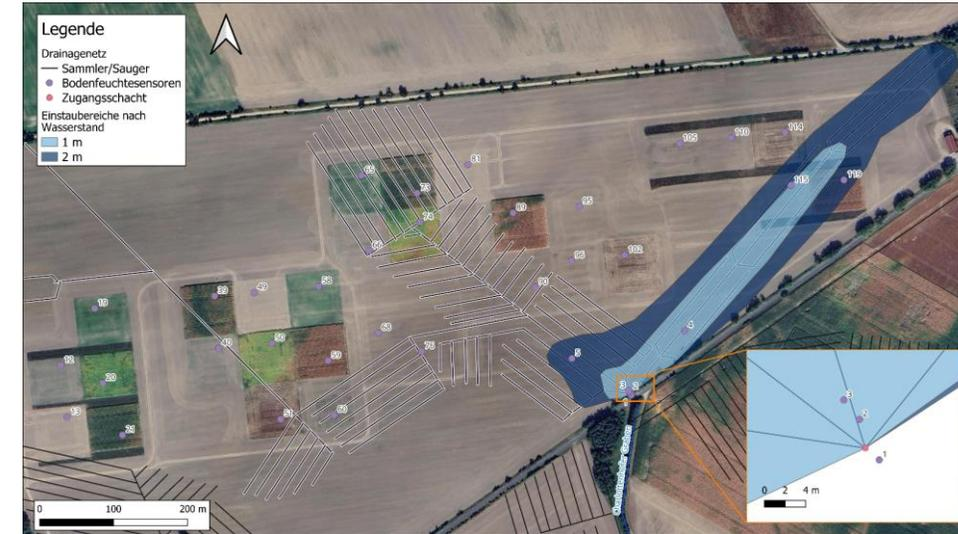
Einstaubereich im Osten des Drainagenetzes, abhängig von Wasserstand und Neigung der Drainagerohre
