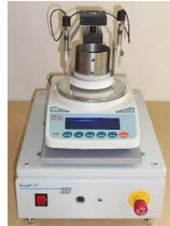
Messgerät zur Messung der Ku-pF-Funktion
