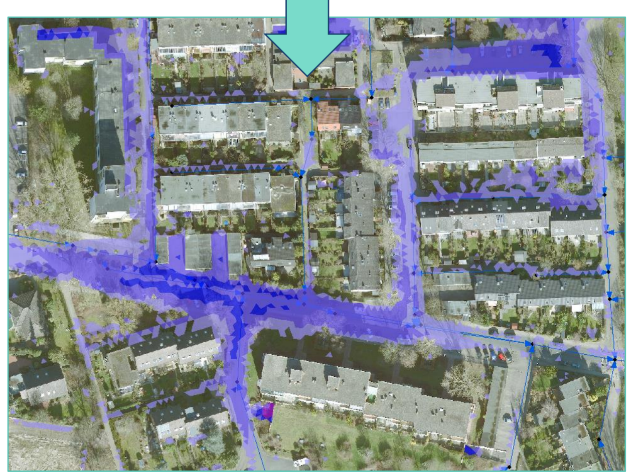
Links: Ansatz des interdisziplinär vernetzten Digitalen Zwillings (Quelle: eigene Darstellung) Rechts: Radar-Niederschlagsdaten und resultierende Überflutungsgefährdung (Quelle: SEH)
