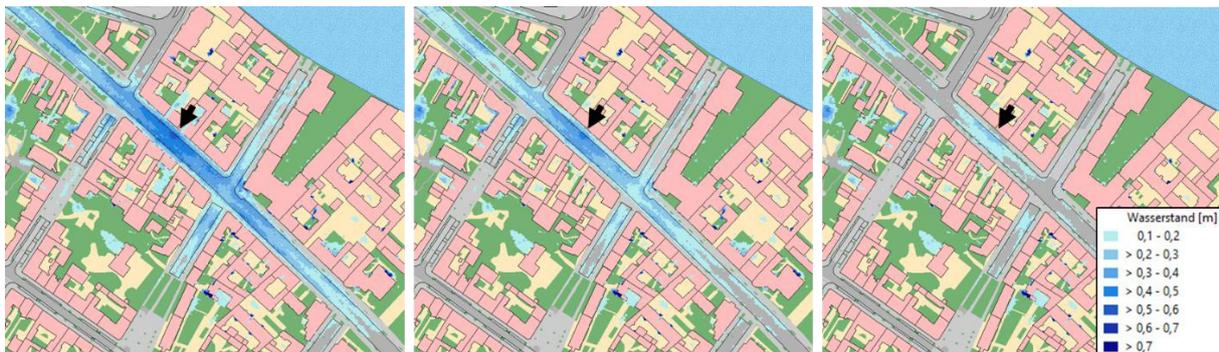
Abbildung 3-2: Maximale Wasserstände im Überflutungsschwerpunkt (siehe Anhang 1, roter Kreis) infolge R1. Von links nach rechts: Referenzmodell, Mulden (5 a): Impl. 50 % und 100 %
