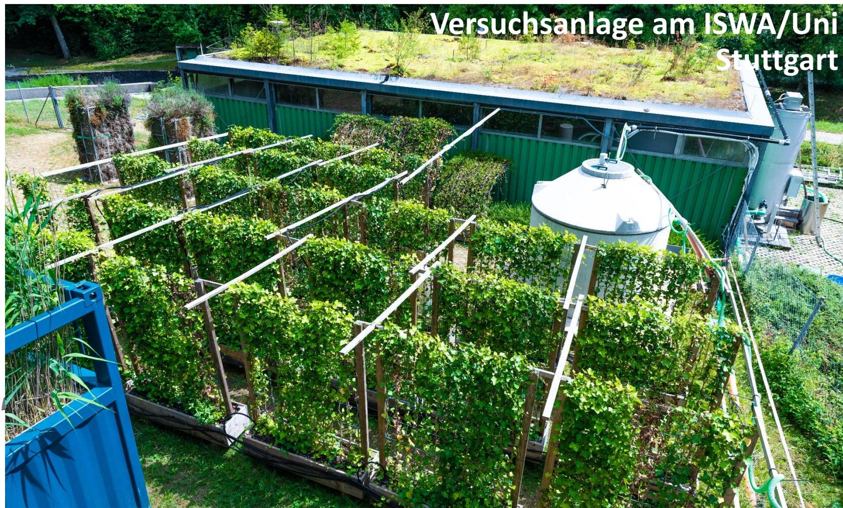
Abb.: Efeu-Fassadenmodulung des Grünzählers mit Betriebswasserpeicher.
